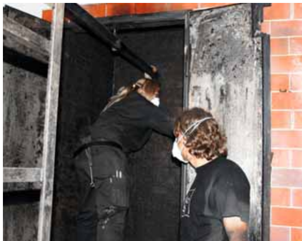
Figura 6 mentre una persona si trova nella camera di combustione (camera a fumo), l'altra la sorveglia dall'esterno.
